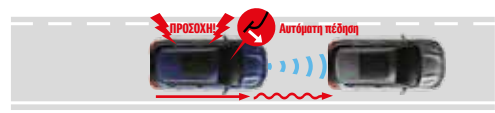
Περίπου 1 δευτερόλεπτο πριν τη σύγκρουση (ανάλογα με την ταχύτητα). Συνθήκες λειτουργίας Απέναντι σε ακίνητα εμπόδια: Λειτουργεί σε ταχύτητα οχήματος περίπου από 5 χλμ/ώρα έως 30 χλμ/ώρα. Απέναντι σε κινούμενα εμπόδια: Λειτουργεί σε ταχύτητα οχήματος πάνω από περίπου 5 χλμ/ώρα.
